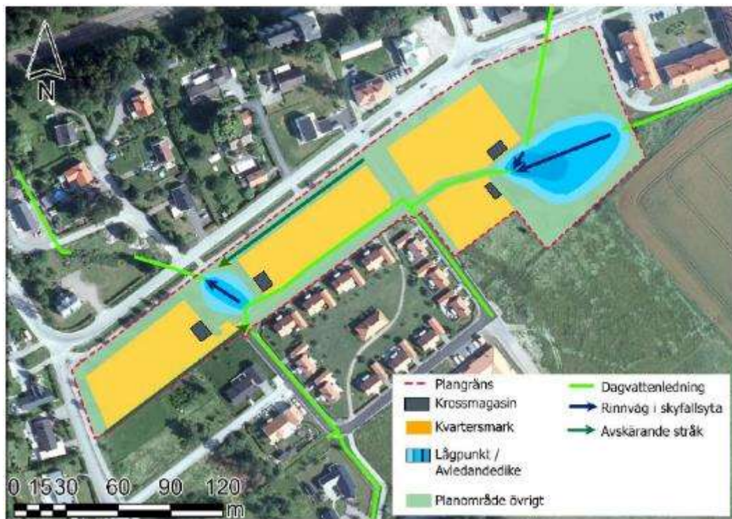
Figur 28. Föreslagen systemlösning för dagvattenhanteringen inom området.
