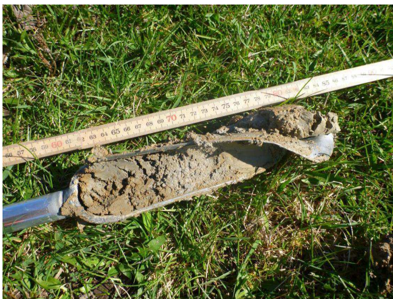
Bild 3. Prov uttaget med hjälp av spadborr.
