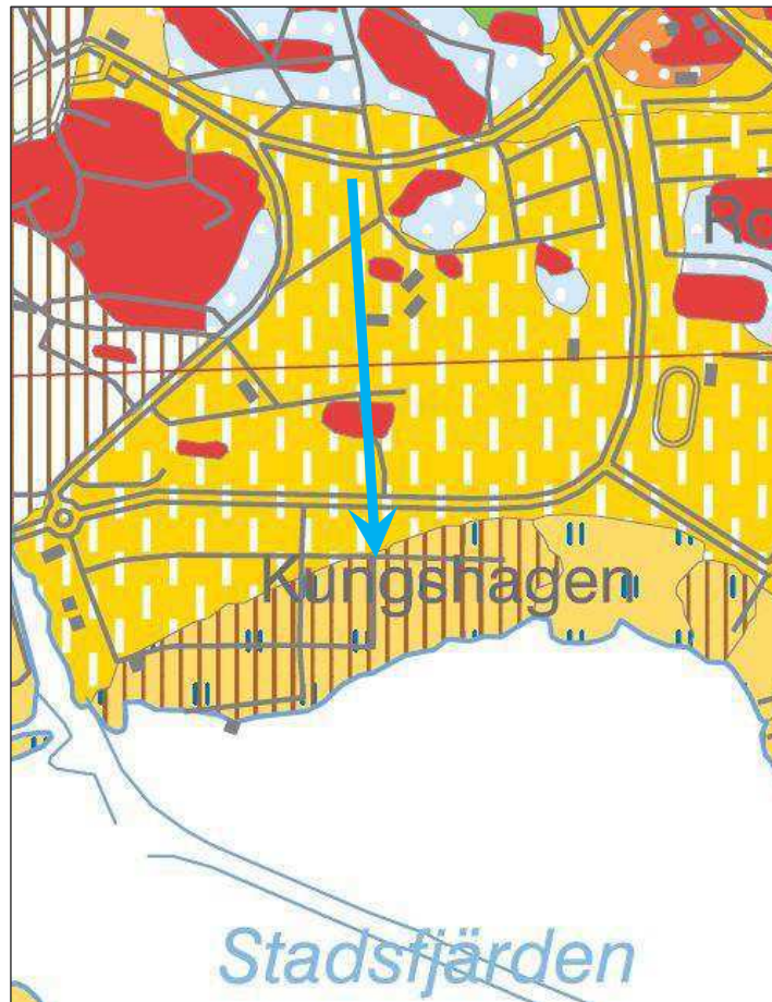
Bild 2. Preliminär konceptuell modell på jordartsgeologisk karta. Orange med vita lodräta streck är glacial silt, blå områden med vita prickar är sandig morän och rött är berg. Blå pil visar preliminär potentiell spridningsväg med grundvatten.
