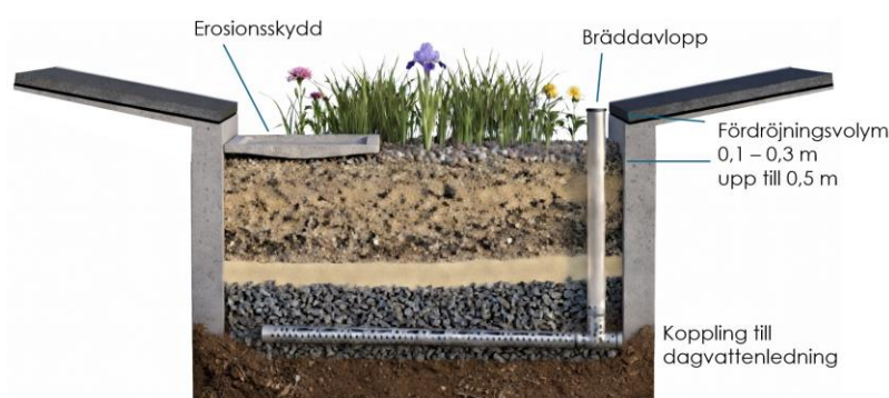
Figur 40 Principskiss för nedsänkt växtbädd med ytlig fördröjningsvolym och dränering
