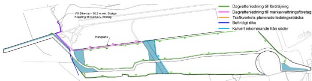
Figur 33. Separat kulvertering, med gemensam ledningssträcka till markavvattningsföretaget
