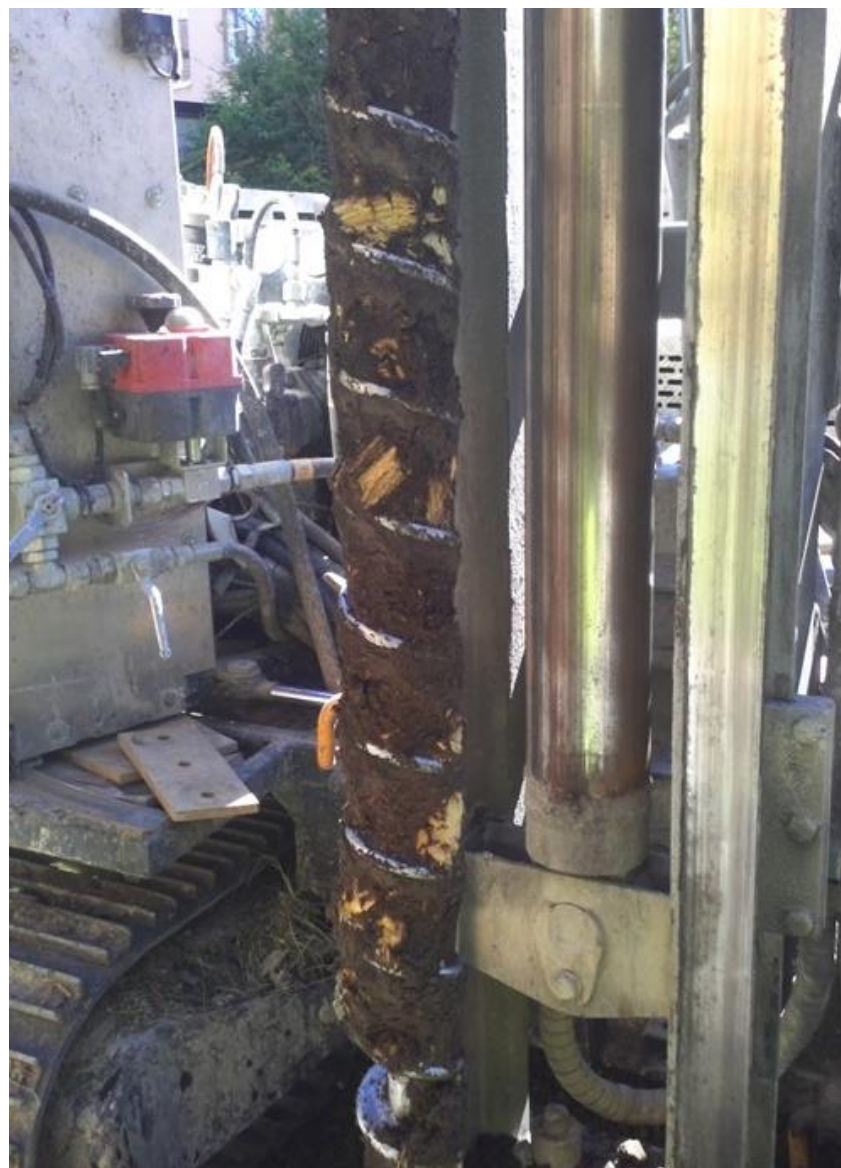
Bild 4: Bild från provpunkt 24INT07 2-3 m. Jordlagret består av mullhaltig jord/gyttja med inslag av större träbitar från byggnadsrester.
