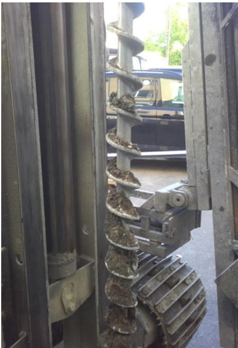
Bild 3: Bild från provpunkt 24INT05 0-1 m. Jordlagret består av fyllnadsmaterial av grus som faller av skruven. Inte lika många tecken på byggnadsrester som i övriga provpunkter.
