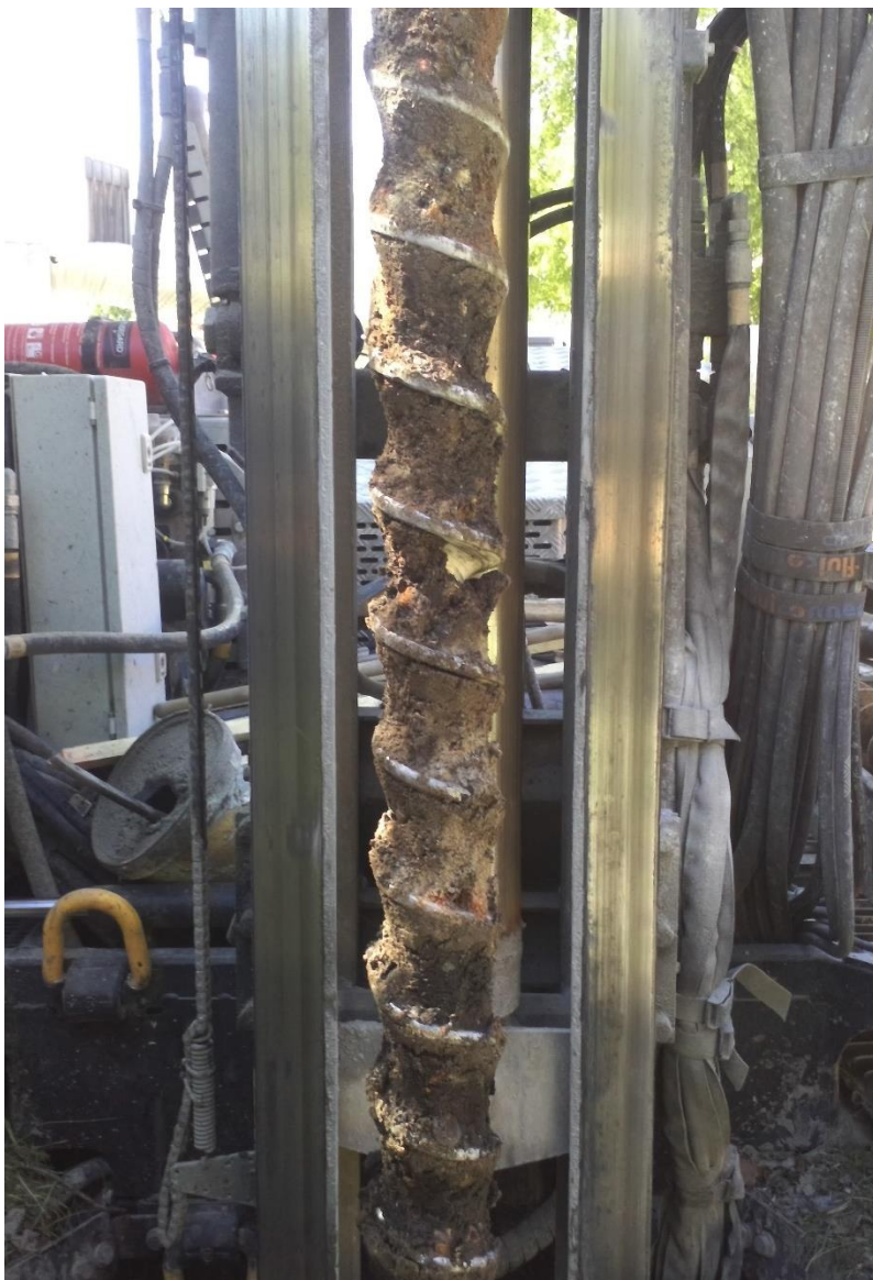
Bild 1: Bild från provpunkt 24INT01 1-2 m. Jordlagret består av mullhaltig jord med tydliga inslag av fyllnads-/byggnadsmaterial i form av träbitar och lite tegel.
