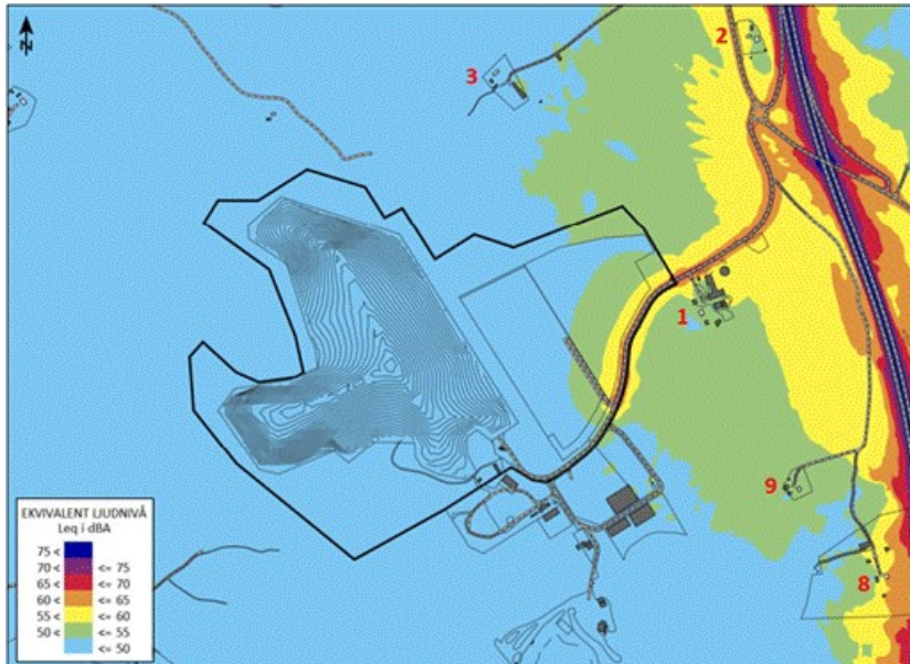
Figur 23. Ljudutbredningskarta vid ett värsta scenario där sluttäckning pågår, och där bulleralstrande verksamheter på 60 och 65 dBA pågår, med den ljudligaste nivån närmast Stora Björshult. Bilden visar en situation utan bullerskyddande vall. I ett sådant scenario överskrider verksamhetsbullret 50 dBA ekvivalent nivå vid Stora Björshult. (Efterklang, 2025).
