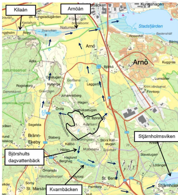
Figur 13. Översiktskarta över avrinningsvägar. Planområdet markerat i svart och flödesriktning med pilar (WSP, 2025).
