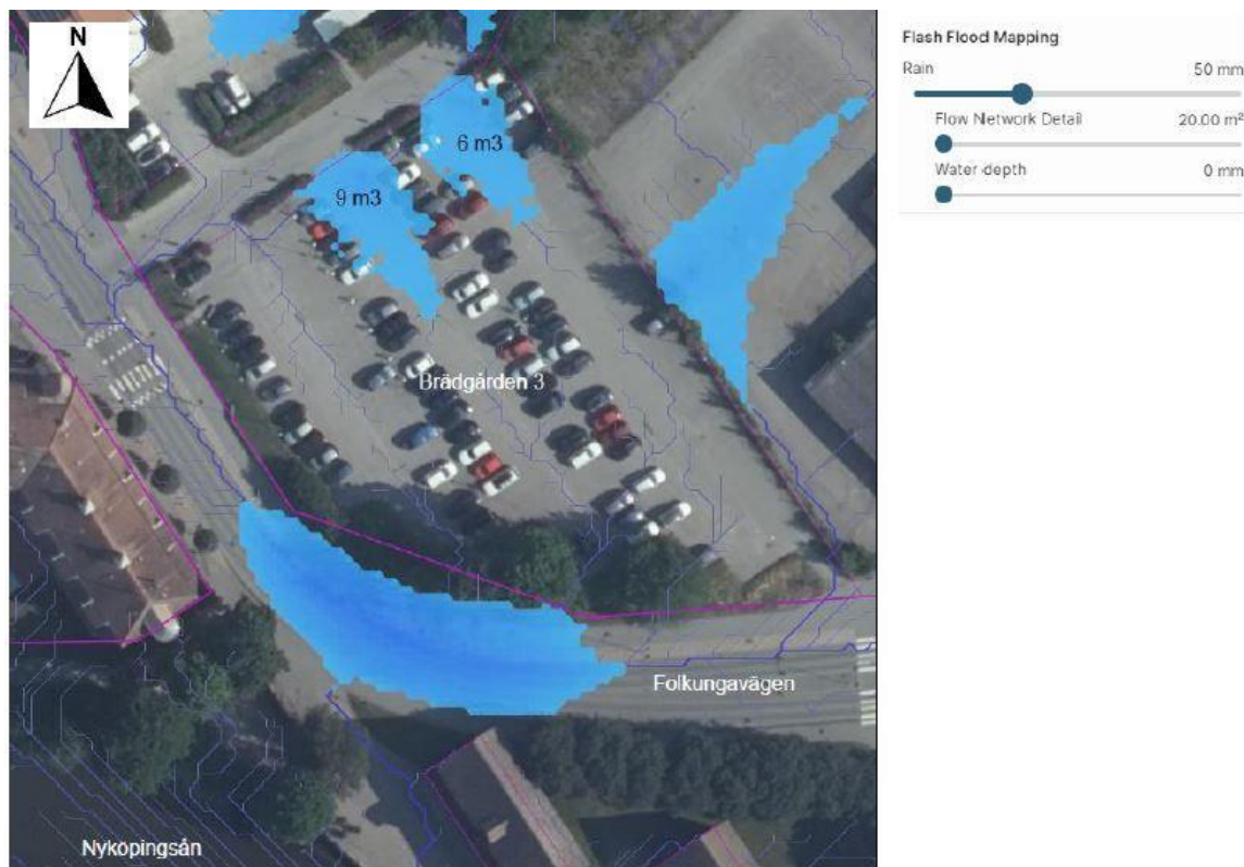
Figur 12: Befintlig situation vid 50 millimeters nederbörd och lågpunkter med volym.
