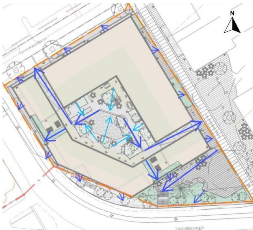
Figur 17: Ytliga avrinningsvägar i framtida planerad situation.
