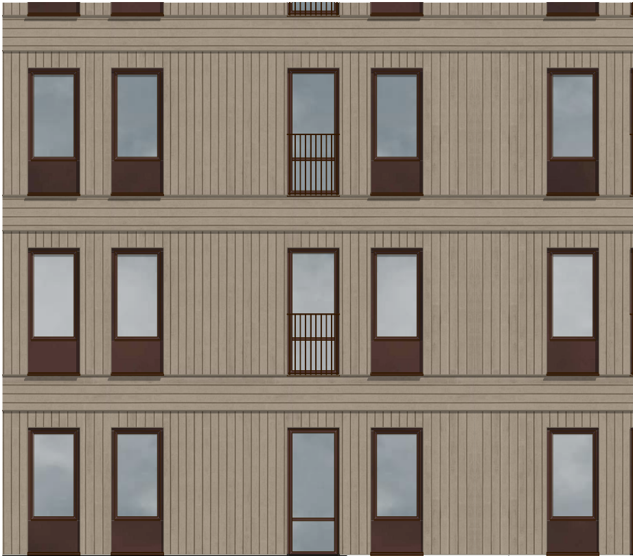
Träfasad med enklare fasaddetaljer mot innergård. Ingen markerad sockelväning.
