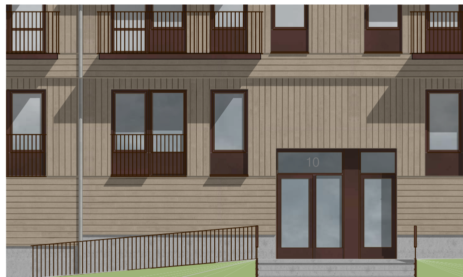
Entré mot Folkungavägen. Indragen och glasade entrédörrar med överljus.
