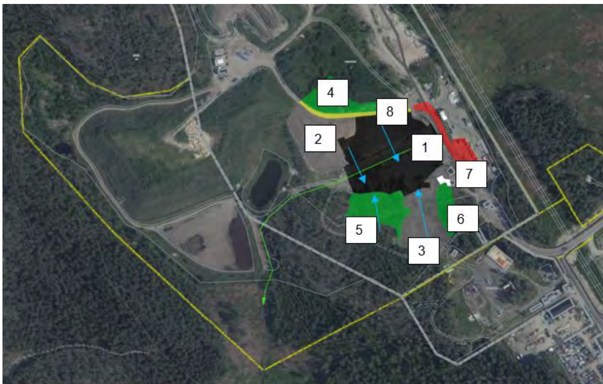
Figur 35. Det bidragande avrinningsområde som idag avleds till lakvattendammen, men som planeras att kopplas bort från lakvattensystemet och ledas till dagvattendamm.
