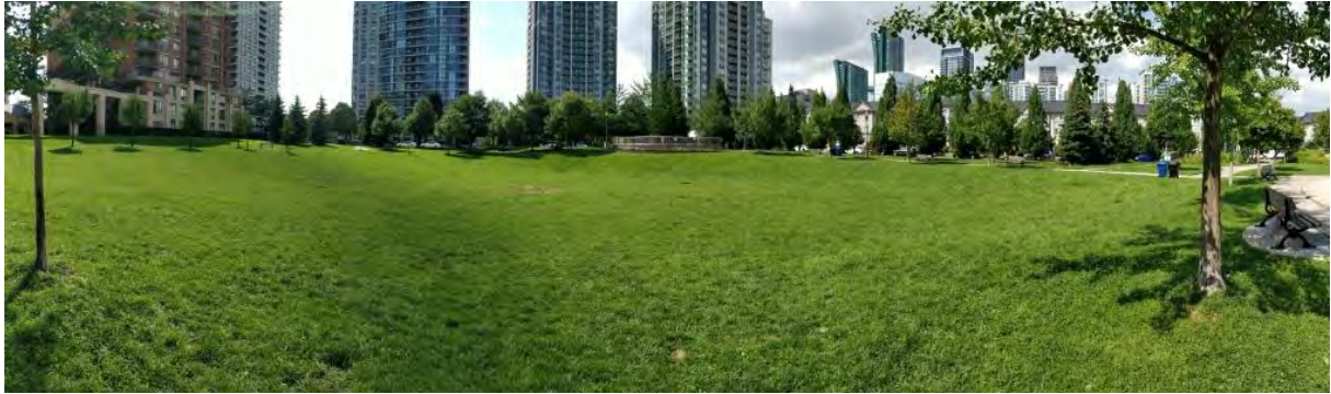
Figur 23 Exempel på torrdamm utformad som nedsänkt gräsyta. Källa: (Sustainable Technologies, 2022)
