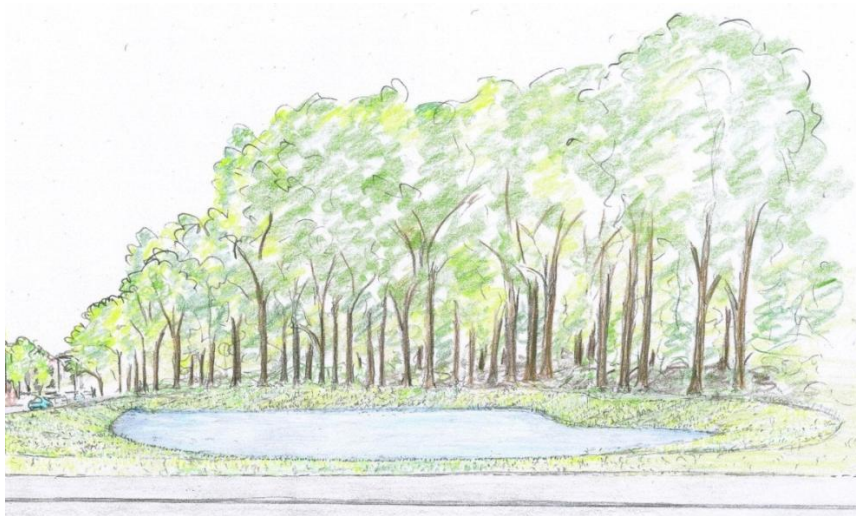
Figur 19: Förslag på hur ett födröjningsmagasin kan utformas (Cecilia Hjort WSP).
