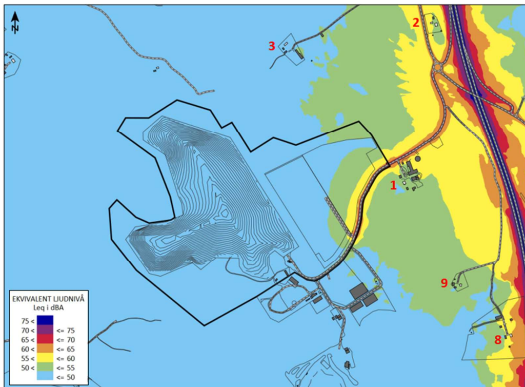
Figur 15: Ljudutbredningskarta för trafikbullret vid prognos för år 2040. Beräkningarna visar att det är bullret från trafiken på väg 53 i öster som är avgörande för de närliggande fastigheternas trafikbullerexponering. (Efterklang, 2025-03-10)
