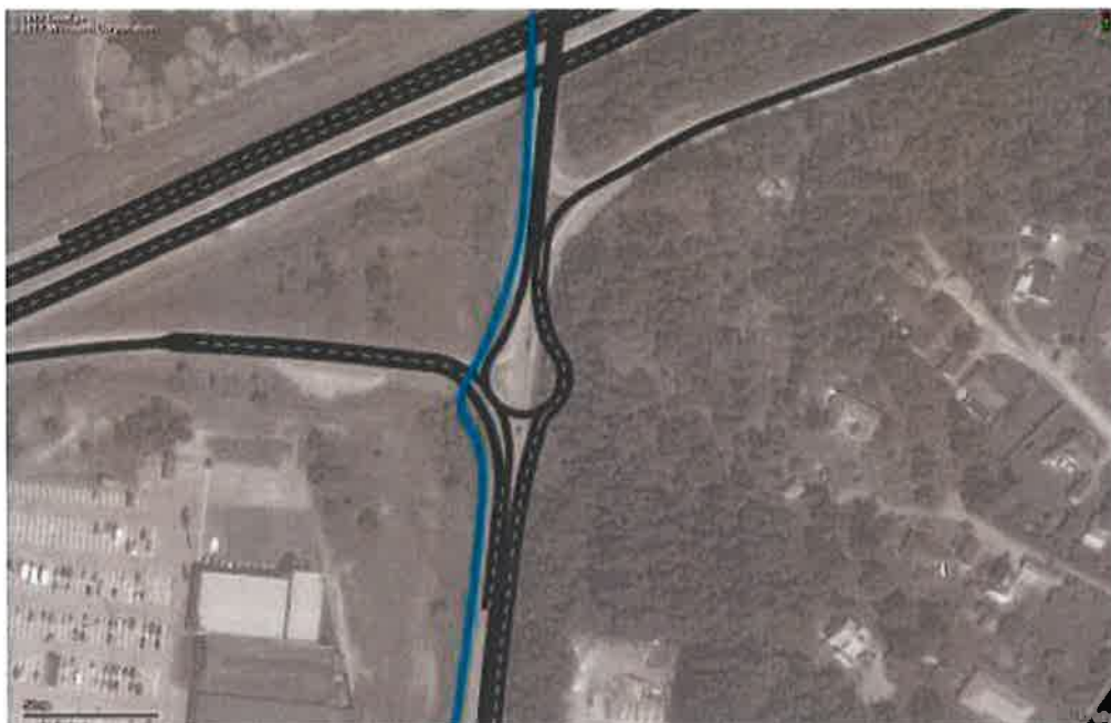
Figur 2: Rekommenderad utformning av av- och påfart E4.
