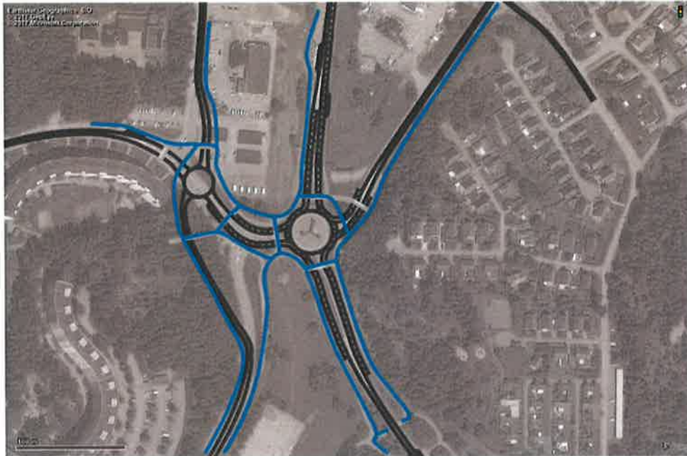
Figur 48 – Principiell utformning alternativ 1. Observera att placeringen av den västra cirkulationsplatsen och dragningen av Stockholmsvägen endast är principiell och att genomförbarheten av den visade lösningen inte är studerad.
