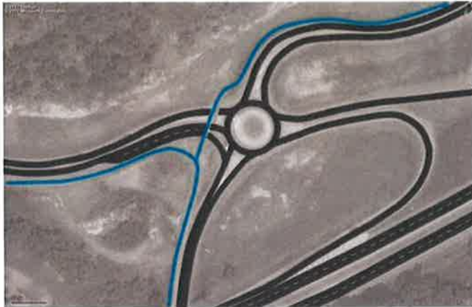
Figur 78 Rekommenderad utformning Stenbocksvägen.
