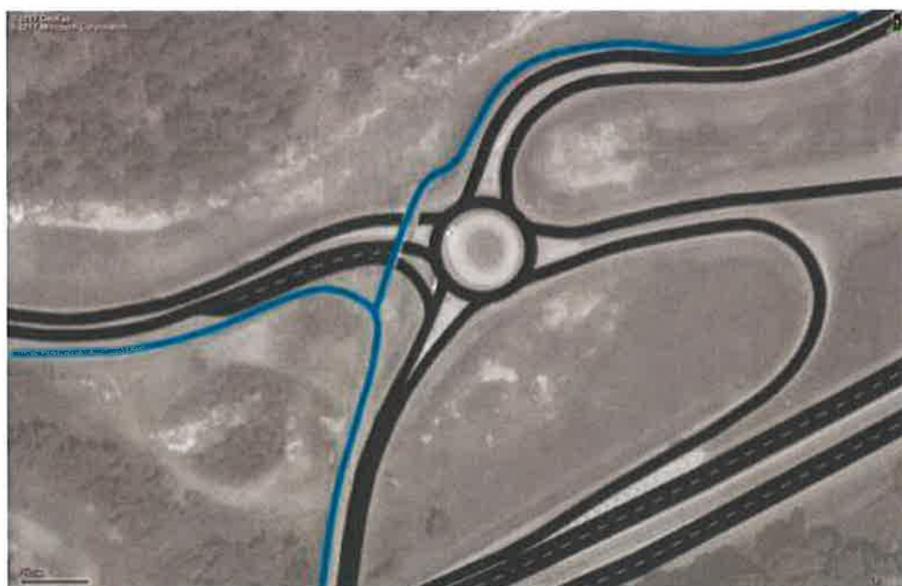
Figur 3: Rekommenderad utformning Stenbocksvägen.
