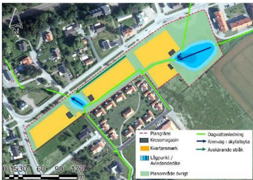
Figur 28. Föreslagen systemlösning för dagvattenhanteringen inom området.
