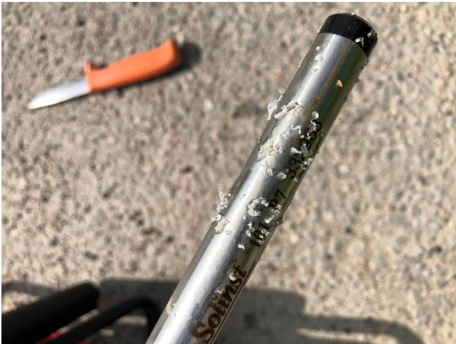
Figur 2. Polyeten (PEH)-partiklar/fragment som upptäcktes på lodet i grundvattenrör 19Ty314.
