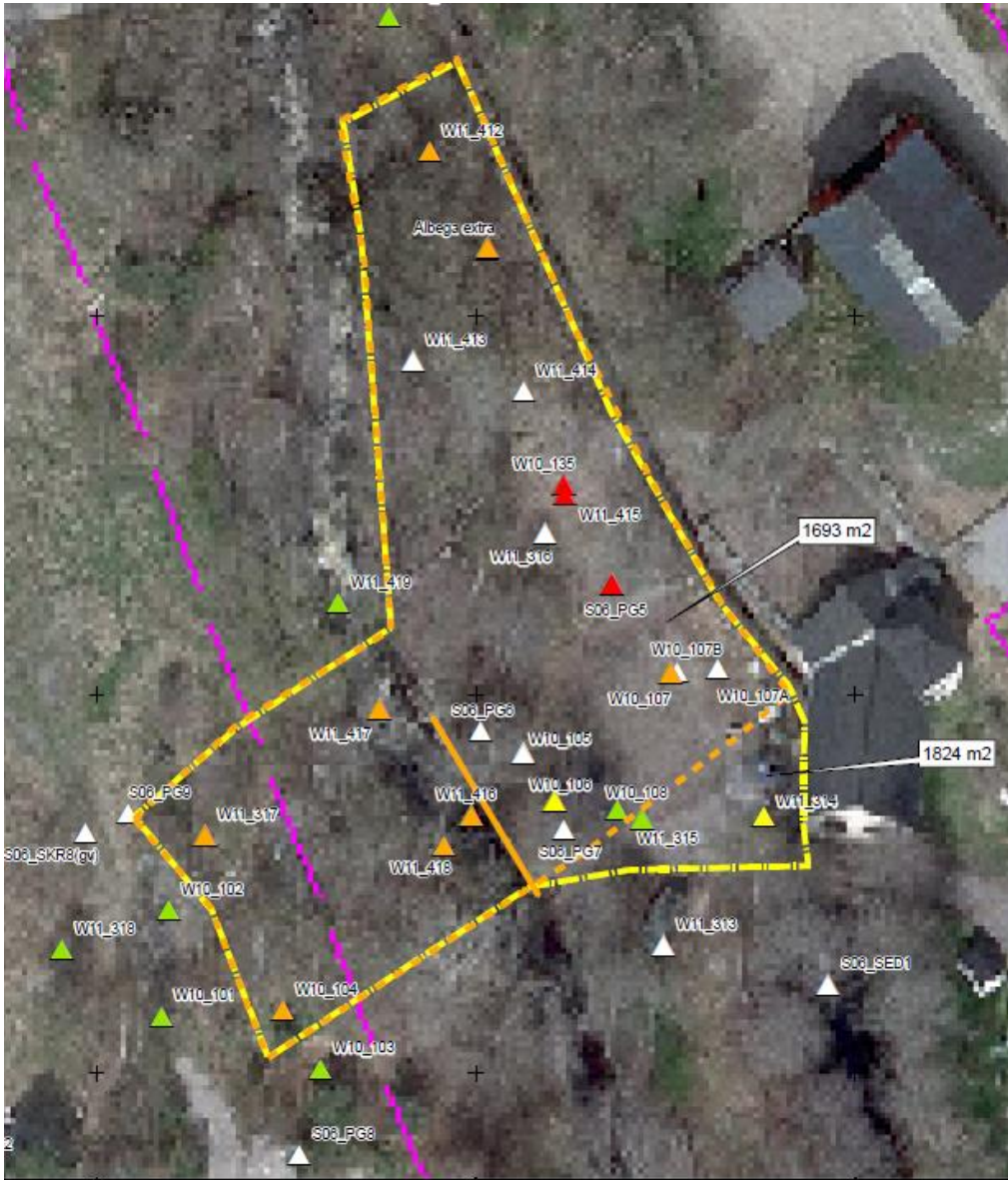
Figur 9. Undersökningsresultat 0-0,5 m u my (Ritning M201d WSP Environmental Huvudstudie f.d. Ålberga såg 2012-03-23). Vit =ej analyserad, grön = halter under KM, gul = halter över KM, orange = halter över MKM, röd = halter över FA.
