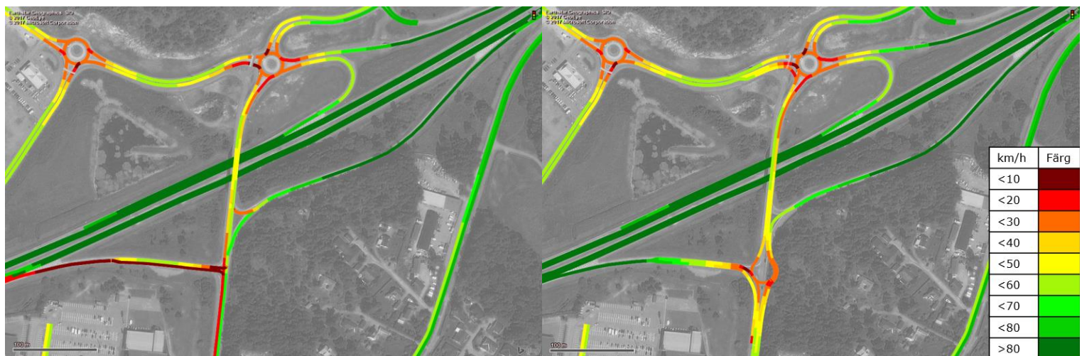
Figur 22 Medelhastigheter (km/h) korsning 1 & 2, eftermiddag, nulägesinfra tv. och rek. alternativ th.
