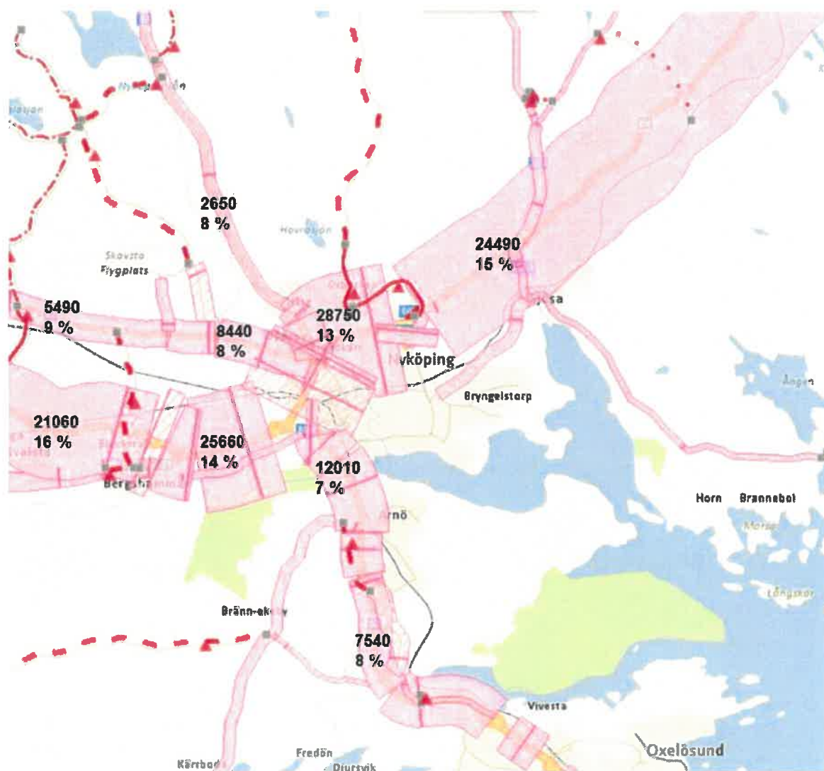
Figur 13. Trafikflöde uttryckt i årsmedeldygnstrafik (f/d) där procenten anger andel tung trafik (från Vägtrafikflödeskartan)
